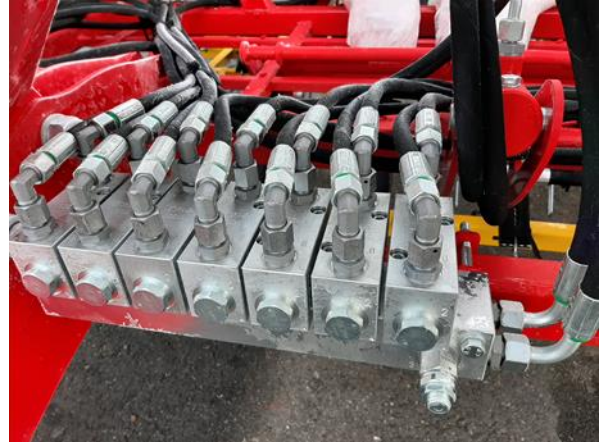
Figure 14 : Diviseur de débit sur le cadre central
